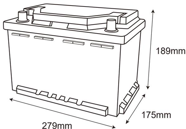
DIN-Standardabmessungen L279\*W175\*H189 mm
